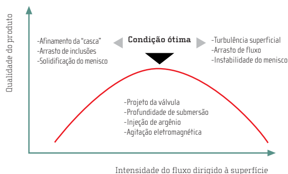
Figura 4 | Resumo do efeito dos parâmetros de escoamento sobre o escoamento dirigido a superfície e efeitos na qualidade do produto[7]
